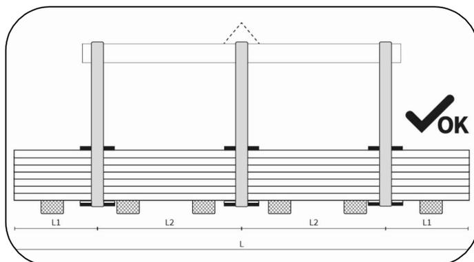
Lors de la manutention, les paquets doivent toujours être élingués en deux points au moins, dont la longueur ne doit pas être inférieure à la moitié de la longueur des paquets.
