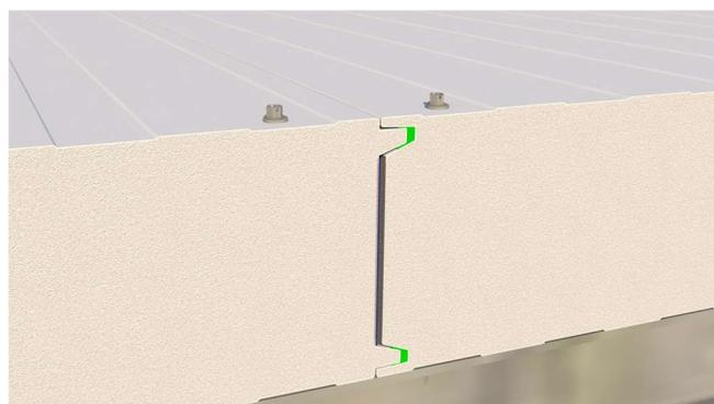
De la même manière, poser les panneaux suivants jusqu'à la fin de la bardage.
