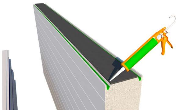
Une fois le solin posé, fixé à la structure dans le sens horizontal, localiser le point de commencement de la pose du premier panneau sur les plans d'exécution.
