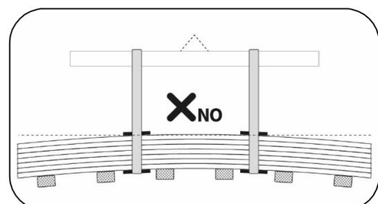
En l'absence d'étrier, le déchargement peut, dans certains cas, être effectué à l'aide de **chariots élévateurs à fourches** appropriés. Pour éviter d'endommager le panneau, voire de casser le paquet, l'équipement de levage doit dans ce cas avoir un écartement et une largeur de fourches qui tiennent compte de **la longueur** du paquet, de son **poids**, ainsi que de **l'épaisseur des panneaux** qui influencent la flexion du paquet.
