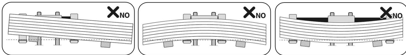
La manutention des panneaux sur le chantier doit être effectuée à l'aide de **systèmes de levage** appropriés, **conçus et dimensionnés** de manière à ne pas endommager le matériau lors de l'assemblage.
