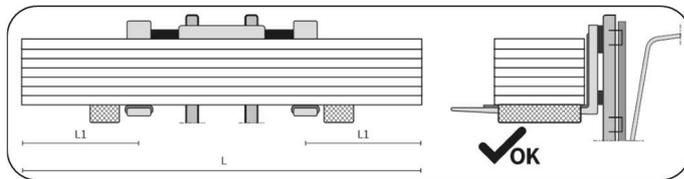
Si le paquet est soulevé de manière déséquilibrée, sans tenir compte des points de préhension corrects, il y a un risque de chute du paquet ou de déformation et endommagement des panneaux.
