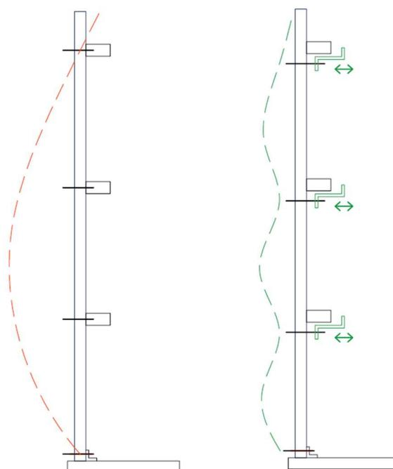
Si le panneau n'était fixé qu'aux extrémités, une incurvation se matérialiserait due aux dilatations thermiques, comme celle représentée en rouge dans la figure. Normalement, les systèmes de fixation prévus pour les panneaux portent, quant à eux, à une incurvation similaire à celle représentée en vert.
